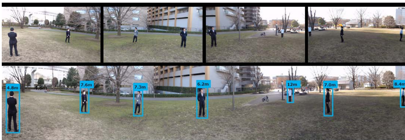
「物体検出ソフトウェアライブラリ」および「測距ソフトウェアライブラリ」によるマルチカメラでの検出・測距例
